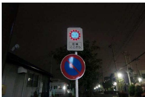
※テスト設置での自発光標識（夜間）
